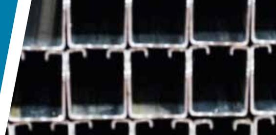
Les profils à froid sont des produits obtenus par profilage en continu de bandes d'acier.
